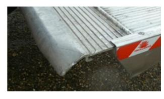
Hayon élévateur: déformations du plateau dans la limite économique de la reparation
