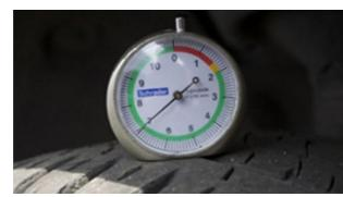
Pneumatiques: profondeur de fond de gorge ≥ 5 mm (CONFORME)
