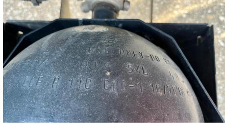
Présence d'un certificat de validité à jour lisible pour bouteille GNC. Nota: Conformément au règlement CEE-ONU R110, chaque bouteille doit faire l'objet d'une inspection visuelle au moins tous les 48 mois après la date de sa mise en service sur le véhicule (immatriculation du véhicule) et lors de toute réinstallation, afin de détecter toute détérioration extérieure.
