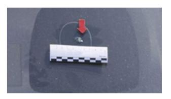
Eclats > 20mm, nombre > 3 éclats, ou éclat dans le champ de vision, fissuré, mal monté avec malfaçon, sablé ou rayé
