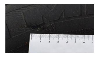
Pneumatiques: entaille ≤ 3 mm de profondeur (CONFORME)
